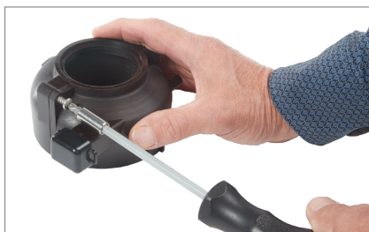
1. Retire los pernos del sensor de inundación.
