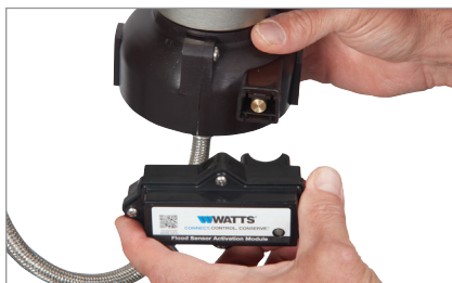
5. Presione el módulo de activación sobre el sensor.
