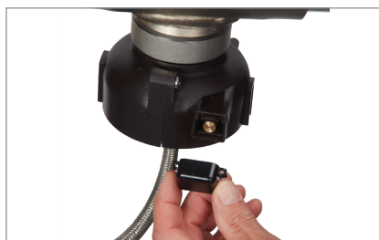
4. Retire la cubierta antipolvo del sensor.
