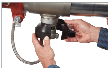
2. Coloque las dos mitades del sensor en la válvula de alivio.
