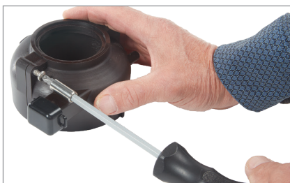
1. Retirez les boulons du capteur d'inondation.
