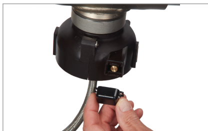
4. Retirez le couvercle antipoussière du capteur.
