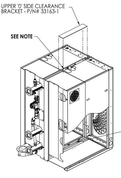
NOTE: BEFORE PLACING THE 2 UNITS SIDE-BY-SIDE TOGETHER, REMOVE THE SIDE PANELS IN BETWEEN FIRST.
